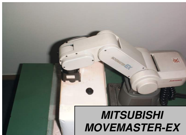
Приступање и адекватно позиционирање и оријентација енд-ефектора робота "MITSUBISHI Movemaster-EX" препознатом објекту
